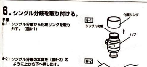
① シングル分岐の本体を押し出す際に、ハブより抜け落ちる場合がございます。厚めのタオル、もしくは厚めのゴム紙の上で行っていただき、抜け落ちない場所で作業を行ってください。キッチン・床・シングル分岐の破損または足の上などに落ちますと大きなケガに繋がる恐れもございます。
